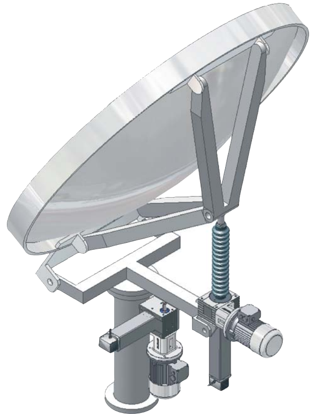
抛物面天线 D = 3.3 \text{ m} , 两个轴 - 方位 + 海拔 - 每个 50 \text{ kN} , 每次移动的行程 0.02 - 0.05 \text{ mm} ; 系统在海岸上露天安装
